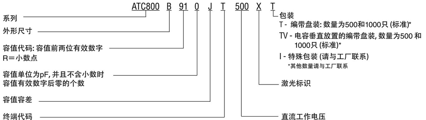
以上是ATC 800 B系列 (外形尺寸B)91pF电容的型号说明, J(±5%)容差, 500V直流额定工作电压, T终端 (镍阻挡层上镀锡, 符合RoHS标准), 激光标识, 编带盘装。
